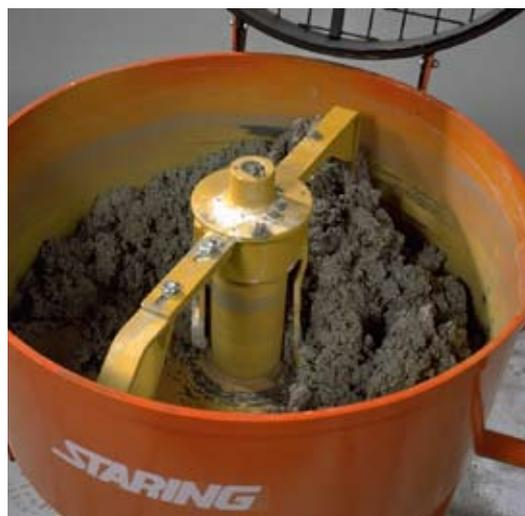
Если время смешивания дольше, чем указано, раствор может потерять свои физические свойства. Это можно проверить, следя за температурой раствора. Если температура начала повышаться, время перемешивания очень длительное. Если подходящая технологичность раствора не достигнута, раствор нельзя использовать. Период годности раствора это период с момента перемешивания до момента непригодности его к использованию.
